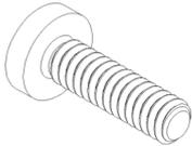
**4x** Vite a testa cilindrica M4x14
